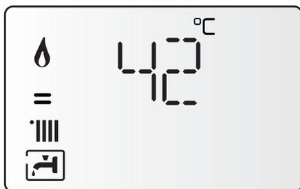
Dans l'exemple ci-dessus, température eau sanitaire : 42 °C Mode sanitaire.
