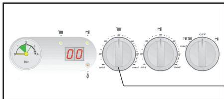
Pour régler la température de l'eau de chauffage, tournez le bouton de réglage de la température chauffage :
