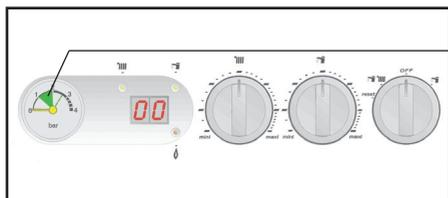
L'aiguille de pression du circuit de chauffage est dans la zone verte entre 1 et 2 bar. Si la pression du circuit de chauffage est inférieure à 1 bar, rajoutez de l'eau dans le circuit jusqu'à 1 bar minimum, 2 bar maximum.
