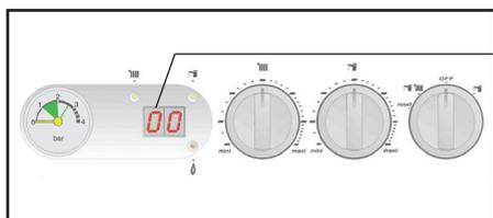
La température de départ chaudière apparaît sur l'afficheur digital.
