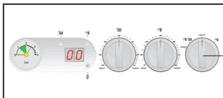
Tournez le bouton de mode de fonctionnement vers la gauche pour le placer sur le mode de fonctionnement hiver
