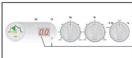
Les codes **E 1** puis **33** disparaissent et la température départ chaudière réapparaît.
