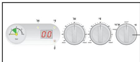
Tournez le bouton de mode de fonctionnement vers la droite pour le placer sur le mode de fonctionnement été ☑.
