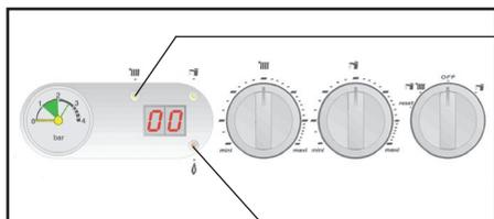
Le témoin de fonctionnement en mode chauffage est éclairé en vert.
