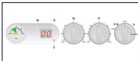
Tournez le bouton de mode de fonctionnement vers la gauche pour le placer sur le mode de fonctionnement hiver ❄️🏠.
