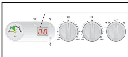
La température de départ chauffage apparaît sur l'afficheur digital.
